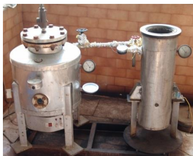
شکل ۱- رآکتور بخارزنی برای تیمار بخار گرمایی چوب صنوبر
