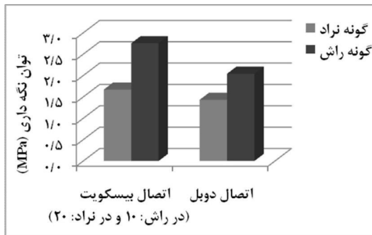
شکل ۶- مقایسه اتصال‌های ساخته‌شده با بیسکویت و چسب PU با اتصال‌های ساخته‌شده با دوپل و چسب PVA
