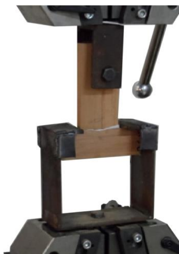
شکل ۳- نحوه بارگذاری بر اتصال‌های ساخته‌شده
