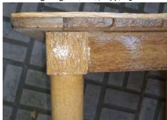
اتصال کام و زبانه پایه به قید جانبی میز
