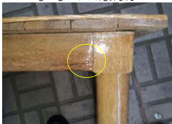
اتصال بین چوبی پایه به قید جانبی میز
