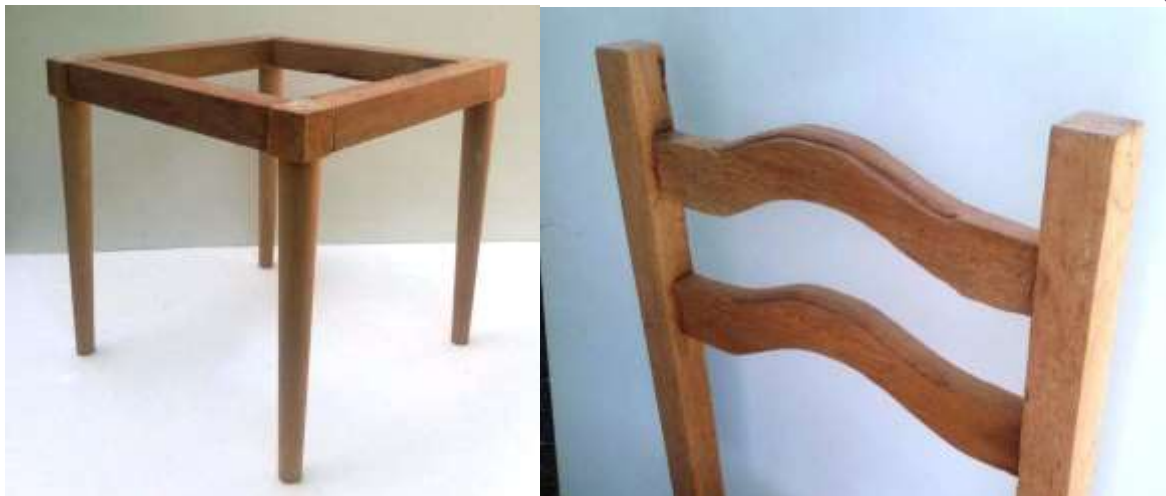
شکل ۴- قابلیت ابزارخوری و خراطی در تاج صندلی و پایه‌های میز
