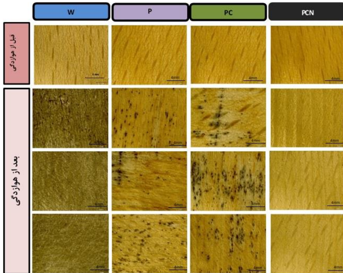
شکل ۵- تصاویر میکروسکوپی از سطح نمونه‌ها قبل و بعد از هوازدهی
