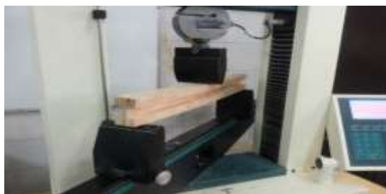
شکل ۳- آزمون تعیین مقاومت خمشی تیر I شکل
