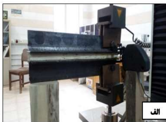
شکل ۲- آزمون چقرمگی شکست: الف) نمونه واقعی DCIB ب) طرح شماتیک از نمونه آزمونی
