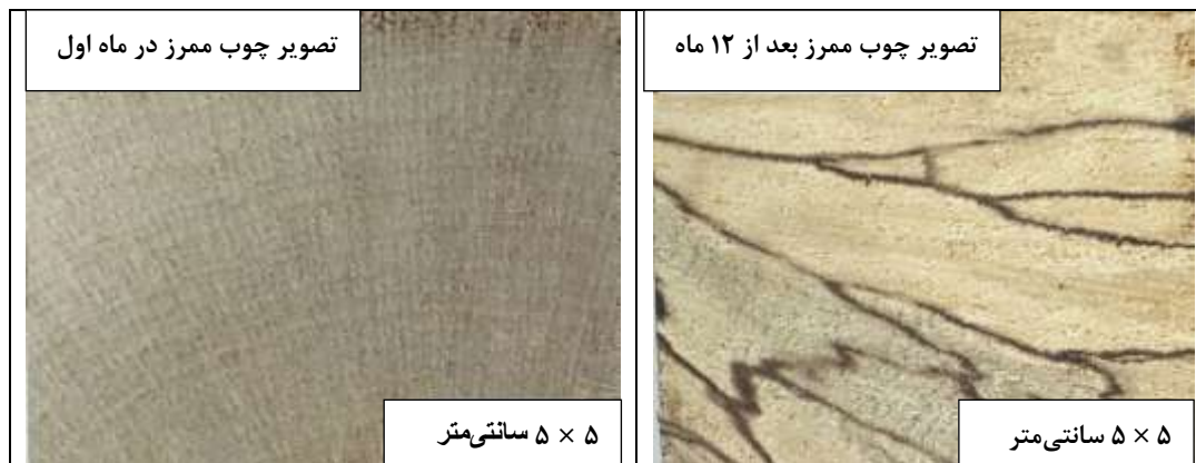
شکل ۳- تغییرات ظاهری مقطع عرضی چوب ممرز پس از ۱۲ ماه نگهداری در جنگل
