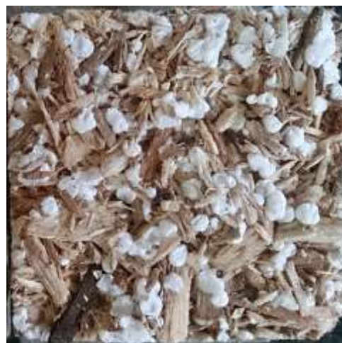
شکل ۳- سطح شکست و وضعیت گرانول‌های پلیمری در نمونه‌های آزمونی با قطر ریز سمت راست و درشت سمت چپ
