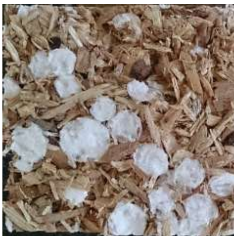
شکل ۳- سطح شکست و وضعیت گرانول‌های پلیمری در نمونه‌های آزمونی با قطر ریز سمت راست و درشت سمت چپ
