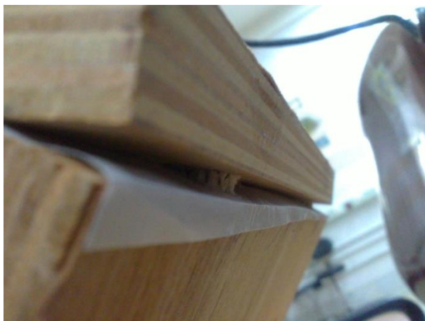
شکل ۷- جدا شدن اعضای اتصال‌های تجربی زیر بار فشاری
