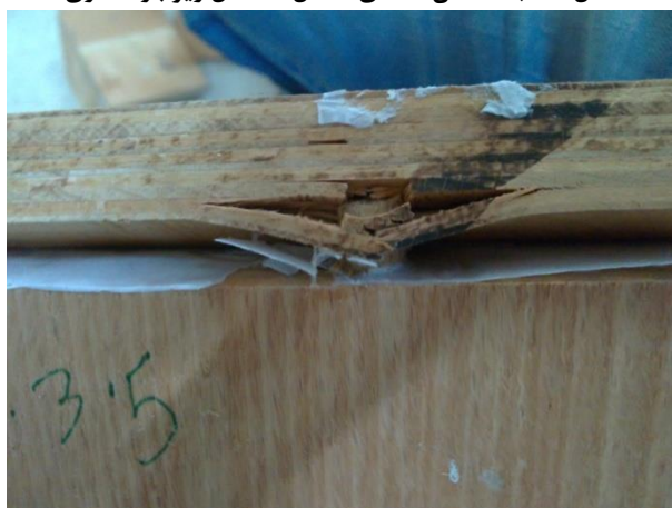
شکل ۹- شکست اعضای اتصال L شکل زیر فشاری
