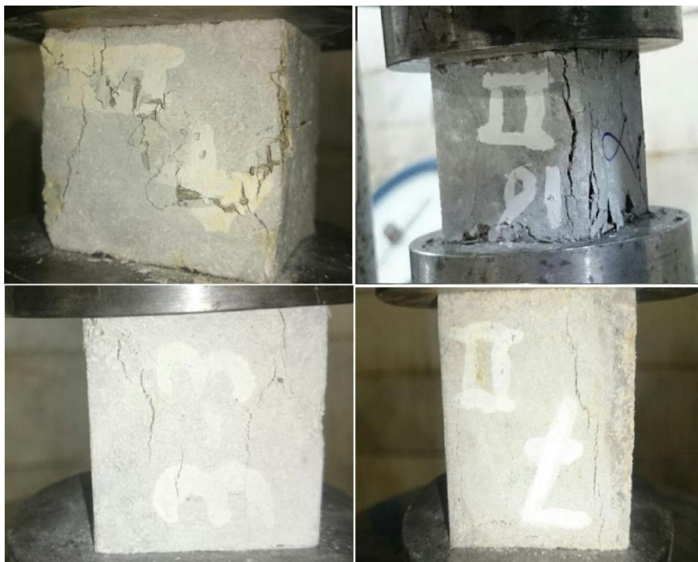
شکل ۴- نوع شکست بتن تحت بار فشاری
