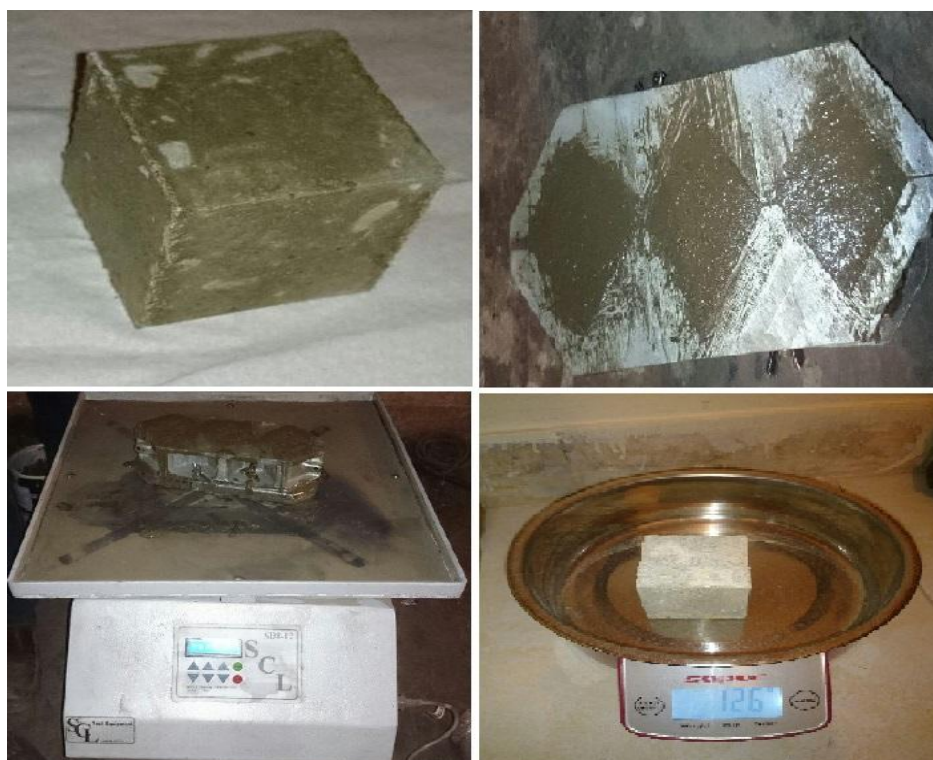
شکل ۲- بتن ساخته شده و نحوه ساخت آن‌ها، نمونه بتن (بالا سمت چپ)، قالب حاوی بتن (بالا سمت راست)، میز ویبره و ویبره کردن بتن (پایین سمت چپ)، وزن نمونه بتن (پایین سمت راست)
