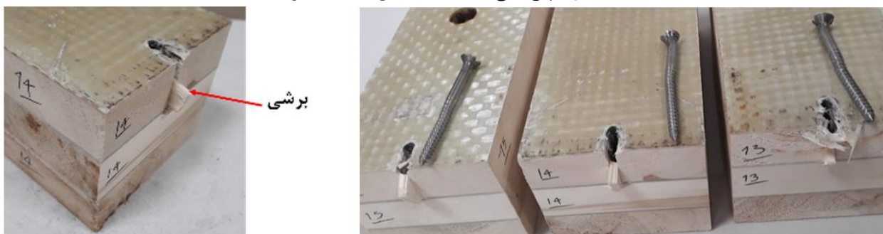
(ه) اتصال با پیچ چوب، با فاصله تا انتهای یک سانتیمتر
