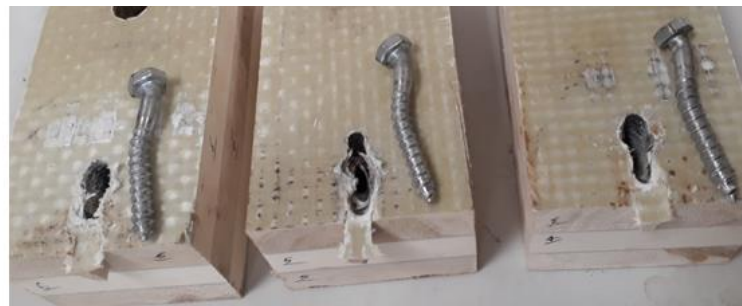
ب) اتصال با پیچ سر مهره، با فاصله تا انتهای سه سانتیمتر
