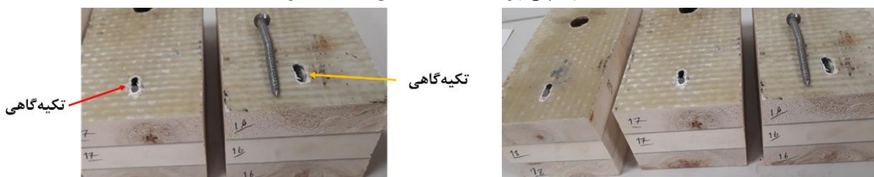
(و) اتصال با پیچ چوب، با فاصله تا انتهای سه سانتیمتر
