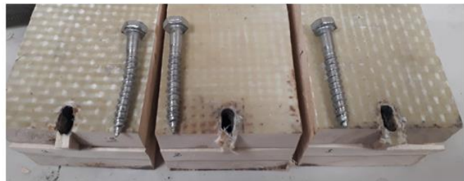
الف) اتصال با پیچ سر مهره، با فاصله تا انتهای یک سانتیمتر
