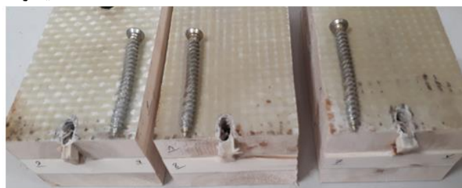
ج) اتصال با پیچ بتنی، با فاصله تا انتهای یک سانتیمتر
