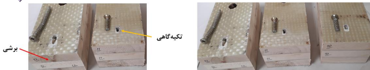
(د) اتصال با پیچ بتنی، با فاصله تا انتهای سه سانتیمتر
