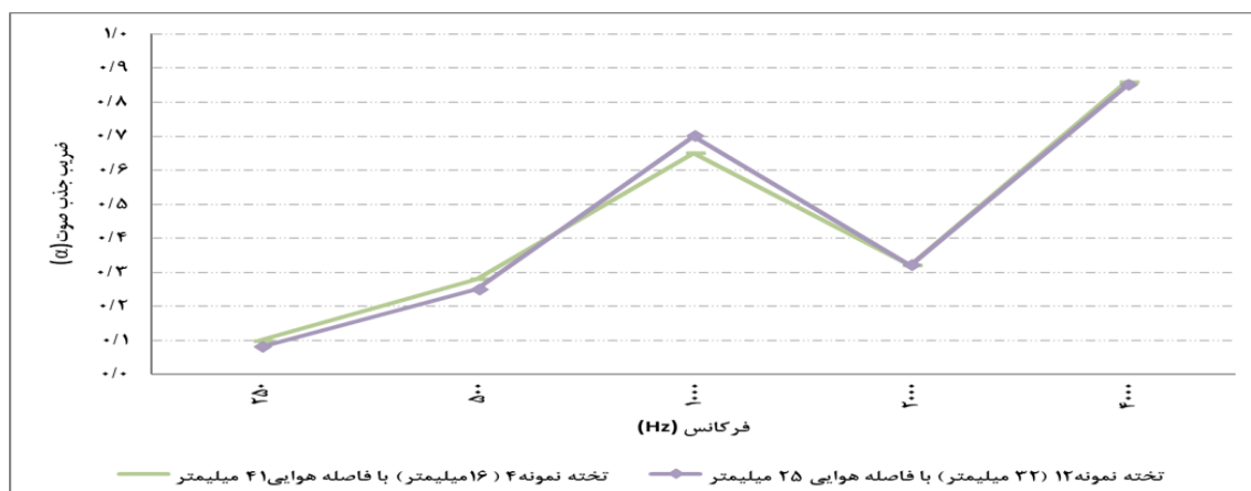
شکل ۱۲. مقایسه ضریب جذب صوت در بهترین نمونه های تحقیق با ضخامت ۱۶ و ۳۲ میلیمتر با فاصله هوایی
