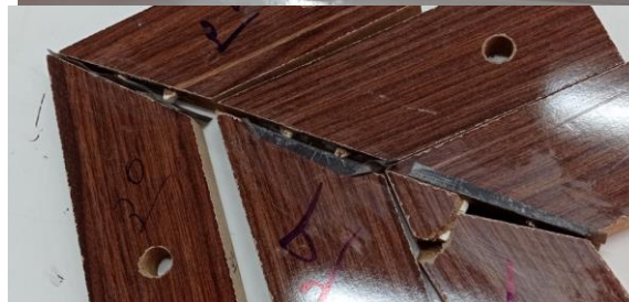
الف) پین‌های فشرده نشده صنوبر با قطر ۸ درصد (شکست ترد پین‌ها در خط چسب، تصویر بالا با یک پین، تصویر پایین با دو پین)
