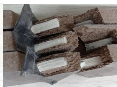
ج) پین‌های با ۳۰ درصد فشردگی با قطر ۸ میلی‌متر (شکست عضو اتصال)
