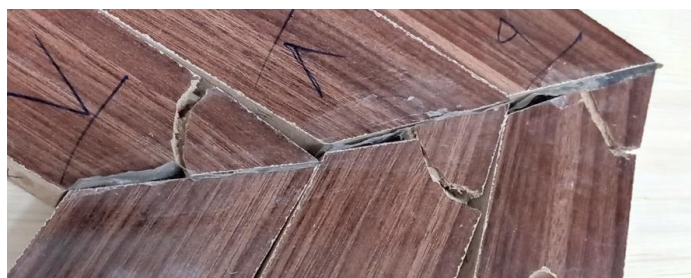
ج) پین‌های با ۳۰ درصد فشردگی با قطر ۸ میلی‌متر (شکست عضو اتصال)
