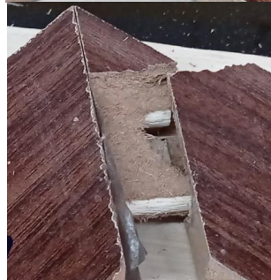
ب) پین‌های با ۲۰ درصد فشردگی با قطر ۸ میلی‌متر (شکست عضو اتصال)
