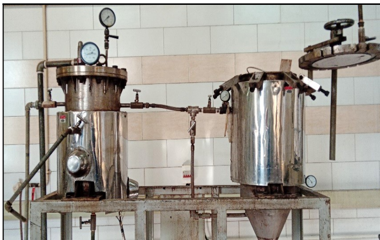
شکل ۱- دستگاه بخارزنی جهت پیش تیمار گرمایی
