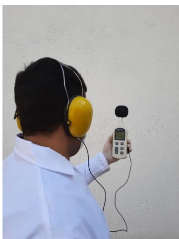
شکل ۲ - دستگاه صوت سنج و روش کار میکروفون داخلی گوشی محافظ
