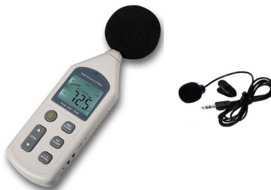
شکل ۲ - دستگاه صوت سنج و روش کار میکروفون داخلی گوشی محافظ
