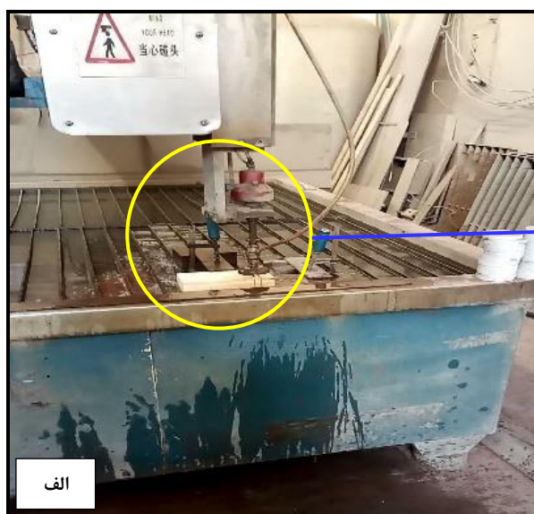
شکل ۲- الف) دستگاه جت آب مورد استفاده در این تحقیق، ب) طرح شماتیک از نازل جت آب و بخش‌های مختلف آن: ۱- ورودی آب با فشار بالا، ۲- یاقوت سرخ یا الماس، ۳- ماده ساینده ۴- مجرای اختلاط، ۵- محافظ، ۶- نازل، ۷- قطعه چوب
