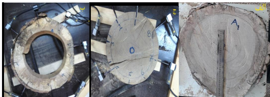
شکل ۱. نشان دهنده: الف) نمونه سالم ب) نمونه بدون چوب درون ج) چوب درون دیسک درخت بلندمازو می باشد
