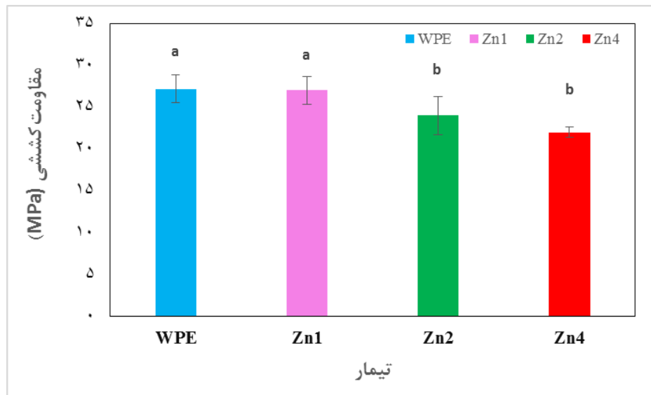
شکل ۳- تأثیر نانو اکسید روی بر مقاومت کششی چندسازه چوب-پلی اتیلن
