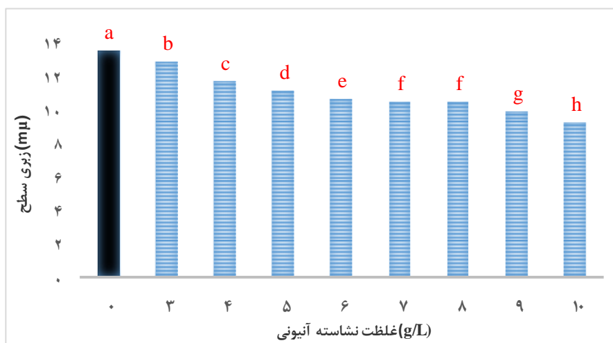
شکل ۸- زبری سطح در غلظت‌های مختلف اعمال سطحی نشاسته آنیونی
