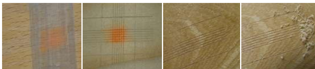
شکل ۱- مراحل آزمون Cross-Cut از راست به چپ
