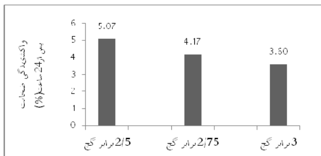
شکل ۱۲- تأثیر میزان گچ بر واکسیدگی ضخامت پس از ۲۴ ساعت غوطه وری در آب
