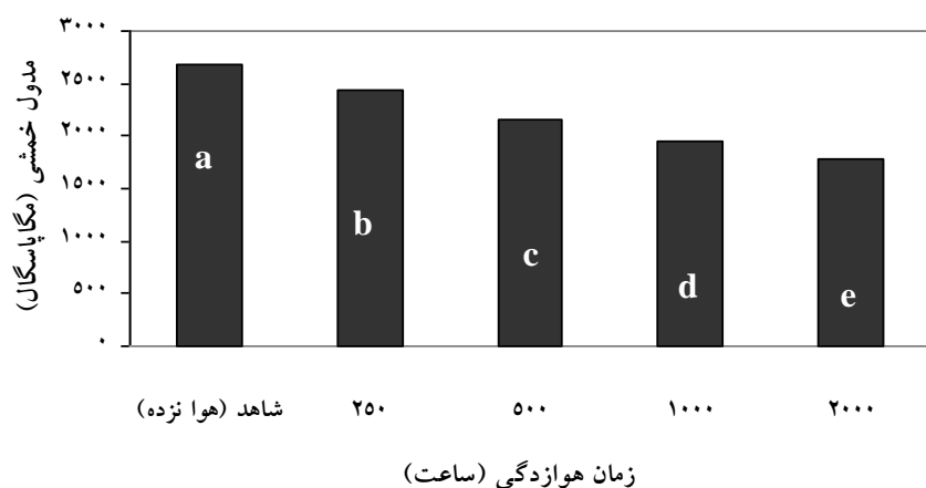
شکل ۲- تأثیر زمان هوازدهی بر مدول خمشی چندسازه آرد چوب- پلی اتیلن سنگین
